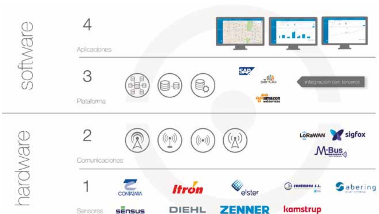
FIGURA 1. Diagrama de la solución end-to-end de telelectura.
